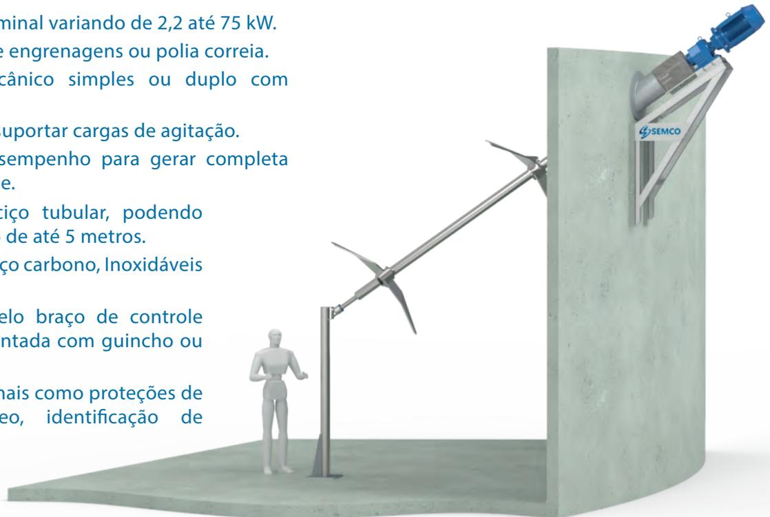
Com objetivo de oferecer um melhor rendimento operacional, economia de energia, elevada vazão, a SEMCO disponibiliza toda sua tecnologia para que os equipamentos propiciem a completa homogeneização da mistura, evitando assim estratificações, separações de fases e desestabilização da mistura pelo excessivo uso do cisalhamento.
